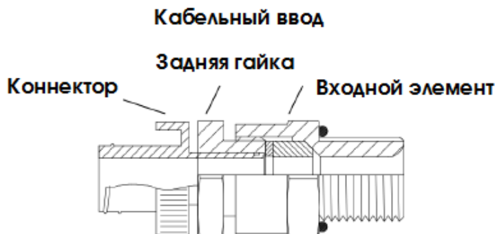
Смонтированный кабельный ввод и кабель
